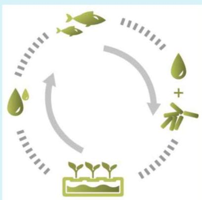
Nell'impianto acquaponico l'acqua circola dalle vasche dei pesci raggiungendo e fertilizzando le piante, per tornare poi nuovamente pulita ai pesci. Questo consente di recuperare tutta l'acqua che le piante non sono state in grado di assorbire riducendo del 90% il consumo di acqua per kg di prodotto rispetto all'agricoltura tradizionale.
