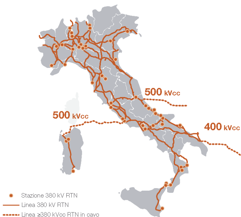
Figura 110 - Distribuzione della rete a 380 kV e dei collegamenti HVDC Sardegna-Penisola Italiana (cd. SA.PE.I.), Grecia-Italia (cd. GR.ITA.) e Montenegro-Italia (cd. MonIta)
