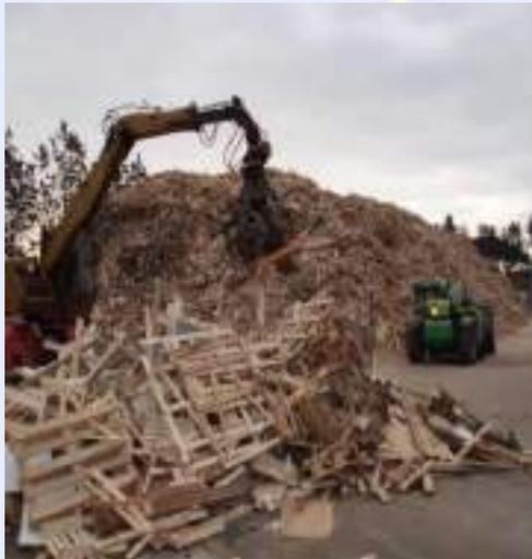
Centrale di cogenerazione di energia elettrica e termica di potenza pari a 1 MWe e 2000 MW termici alimentata con biomasse legnose derivanti da raccolte selettive di imballaggi in legno e da rifiuti dell'attività di selvicoltura (prevalentemente potature di vigneti e oliveti)
