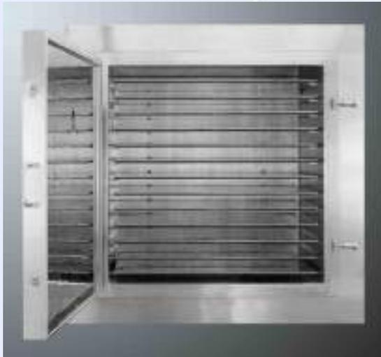
Realizzazione di un impianto di essiccamento sotto vuoto ad armadio con piastre riscaldate idoneo per ambiente farmaceutico. Tale apparecchiatura è da inserire a valle dell'impianto di estrazione dei polifenoli dalle acque di vegetazione (sito nella Provincia di Rieti) permettendone la polverizzazione.
